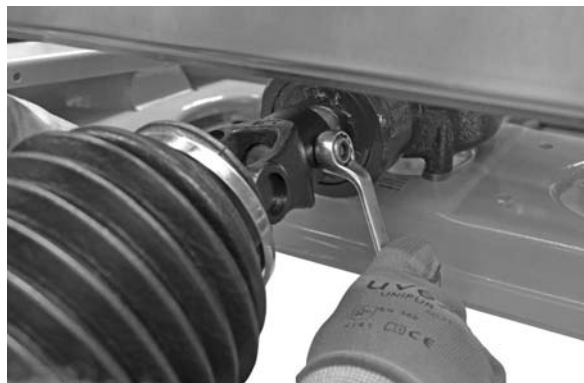
Rysunek 6.3: Podłączenie wału przegubowego
